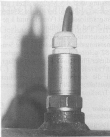
**Bild 3.5:** Methanzahl-Sensor, eingeschraubt in einer Rohrleitung.
